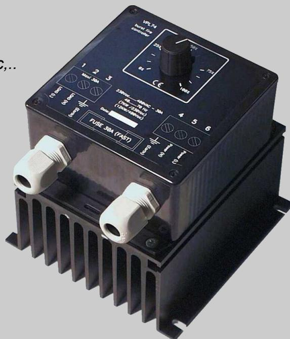
Unité autonome et compacte permettant une commande de puissance proportionnelle des charges résistives par salves variables d'ondes entières , Peut être utilisé avec la plupart des résistances chauffantes.
